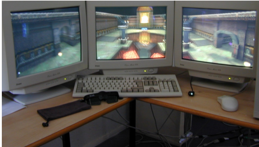
Figure 5.1 CAVE Quake III Arena exécuté sur une grappe grâce à Net Juggler et SoftGenLock [8].
